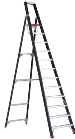
**Standhöhe:** 2,80 m**Arbeitshöhe:** 4,80 m**Sprossen/Stufen:** 12**Trittform:** Stufen**Hersteller:** Altrex**Kategorie:** Stehleiter**Begebarkeit:** einseitig**Tragkraft:** 150 kg
