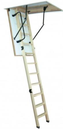
**U-Wert:** 0,85W/m<sup>2</sup>·K**Deckelstärke:** 46 mm**Breite Deckenöffnung:** 70 cm**Ausladung:** 1,55 m**Lichte Raumhöhe:** 280 cm**Hersteller:** Altrex**Kategorie:** Bodentreppen**Länge Deckenöffnung:** 140 cm**Tragkraft:** 150 kg**Material:** Holz
