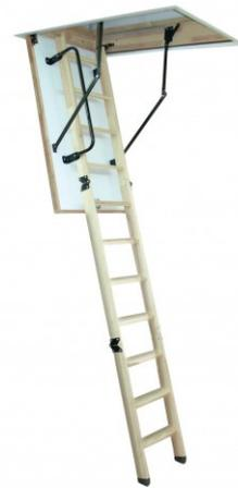
**U-Wert:** 0,85W/m<sup>2</sup>·K**Ausladung:** 1,55 m**Breite Deckenöffnung:** 60 cm**Deckelstärke:** 46 mm**Lichte Raumhöhe:** 280 cm**Hersteller:** Altrex**Kategorie:** Bodentreppen**Tragkraft:** 150 kg**Länge Deckenöffnung:** 110 cm**Material:** Holz
