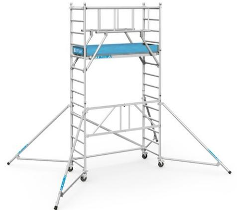
**Gewicht:** 79.5 kg**Gerüsthöhe:** 4,65 m**Standhöhe:** 3,55 m**Arbeitshöhe:** 5,55 m**Plattformbreite:** 0,60 m**Plattformlänge:** 1,80 m**Hersteller:** Zarges**Material:** Aluminium**Kategorie:** Klappgerüst
