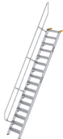
**Gewicht:** 62.8 kg**Senkrechte Höhe:** 3,88 m**Stufenbreite:** 600 mm**Neigung:** 60°**Podest:** nein**Ausladung:** 2,48 m**Sprossen/Stufen:** 16**Trittform:** Stufen**Hersteller:** Munk**Material:** Aluminium**Kategorie:** Treppen
