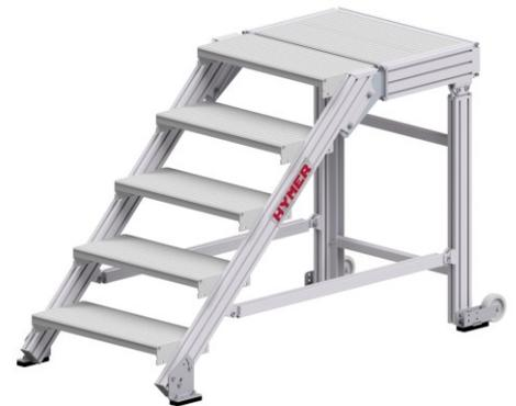
**Gewicht:** 55.1 kg**Plattformlänge:** 400 mm**Standhöhe:** 0,99 m**Ausladung:** 1,61 m**Plattformbreite:** 600 mm**Arbeitshöhe:** 2,99 m**Sprossen/Stufen:** 5**Hersteller:** Hymer**Trittform:** Stufen**Kategorie:** Treppenpodest**Tragkraft:** 300 kg**Eigengewicht:** 55,1 kg**Stufentiefe:** 0,25 m
